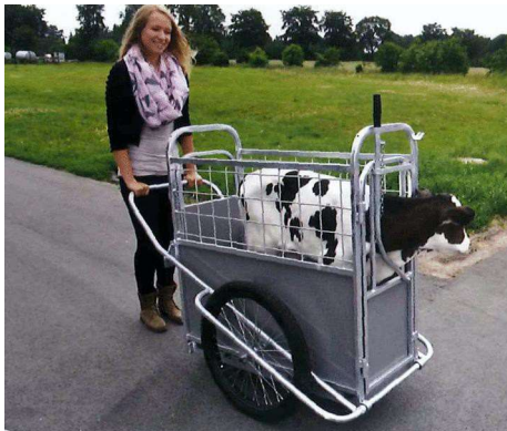
Einachsiger Kälbertransportbox mit integrierter Waage
