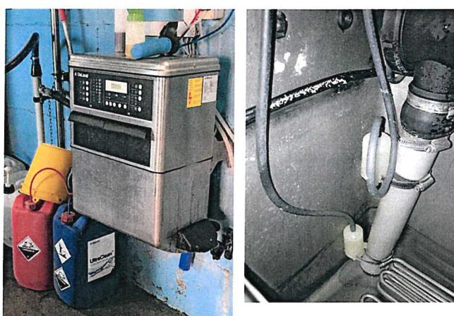
Abbildung 4: Rückstände eines Bismut enthaltenden Zitzenversieglers im Reinigungsautomat.
